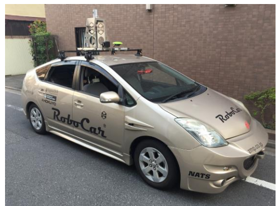
写真 走行データ取得用センサー車両(乗用車)の例
