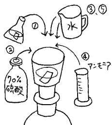
振とうした後の試料を新しい 70%硫酸液、水、アンモニア水、 水で順次洗浄します。
