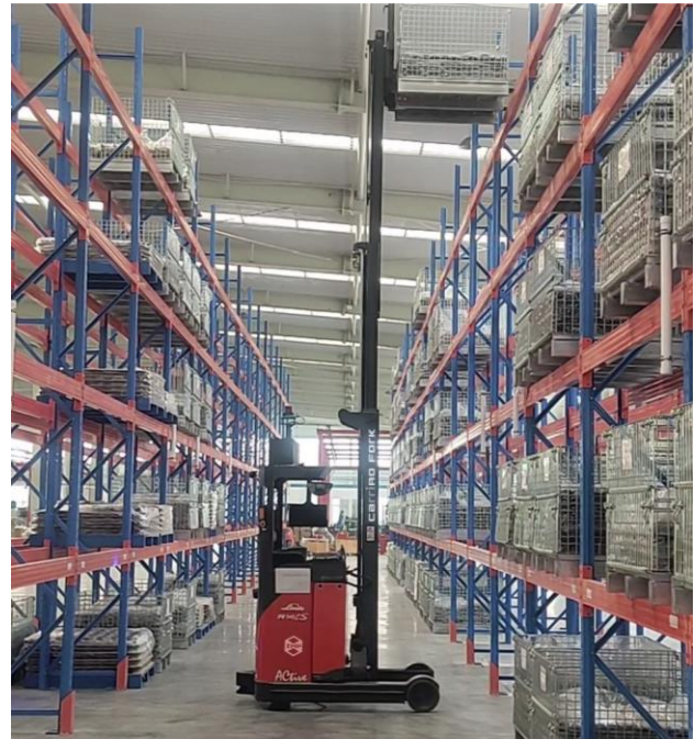
CarriRo® Fork で約 5.6m の高さの棚へパレットを無人で格納している様子
