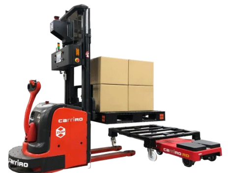
CarriRo® Fork と CarriRo® AD+が連携して パレットの積み下ろしを行う様子
