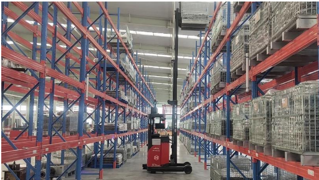
CarriRo® Fork で約 5.6m の高さの棚へパレットを無人で格納している様子
