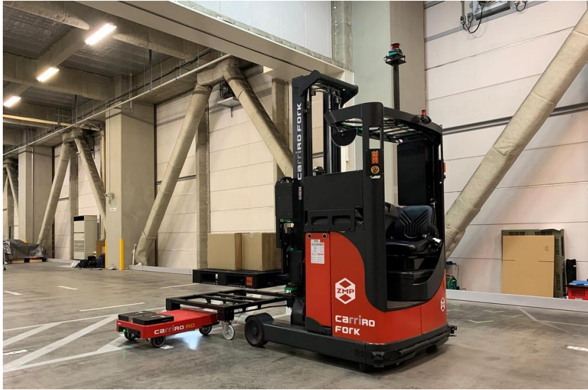
新機能 Fork Eye はパレットを認識し、それに合わせた動作を実施
