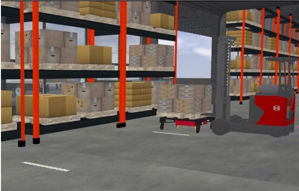
Robo Sim 上での CarriRo AD+と CarriRo Fork の連携シミュレーション。 動作は全て実際の制御に基づいて行われている。
