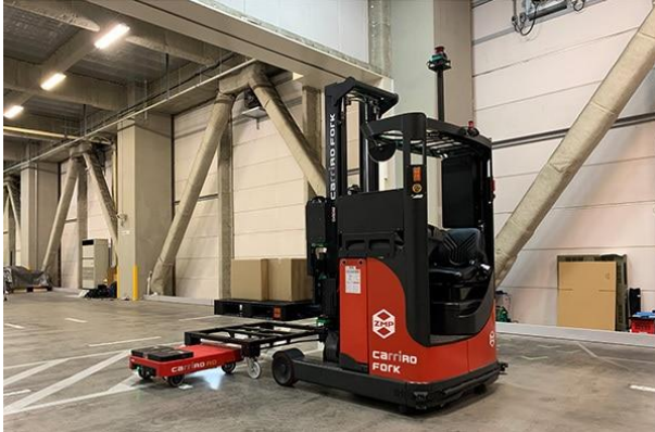
CarriRoAD+が搬送してきたパレットの位置を認識し、パレットを受け取る
