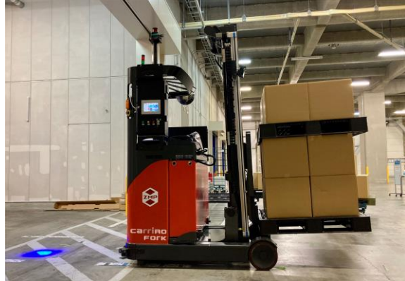
段積みパレットの位置を認識し、パレットを受け取る
