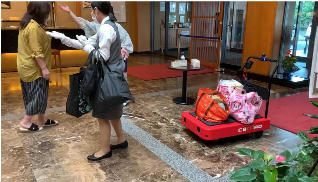
CarriRo ® でお客様のお荷物をカルガモ走行で搬送している様
