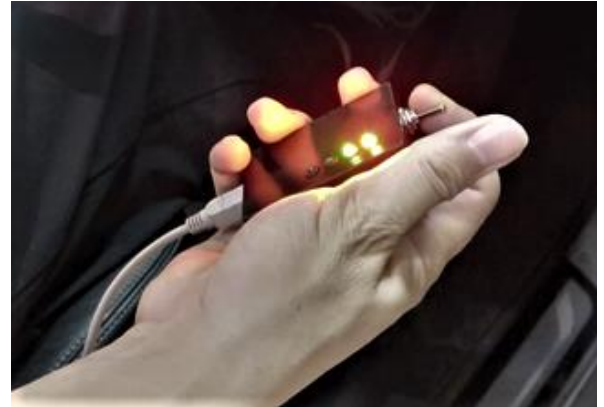
標準装備のインジケータボックス (LED で状態確認、ボタン操作で記録開始・停止が可能)
