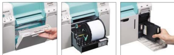
カットすずの取り出し    ペーパーロール交換    インクカートリッジ交換
