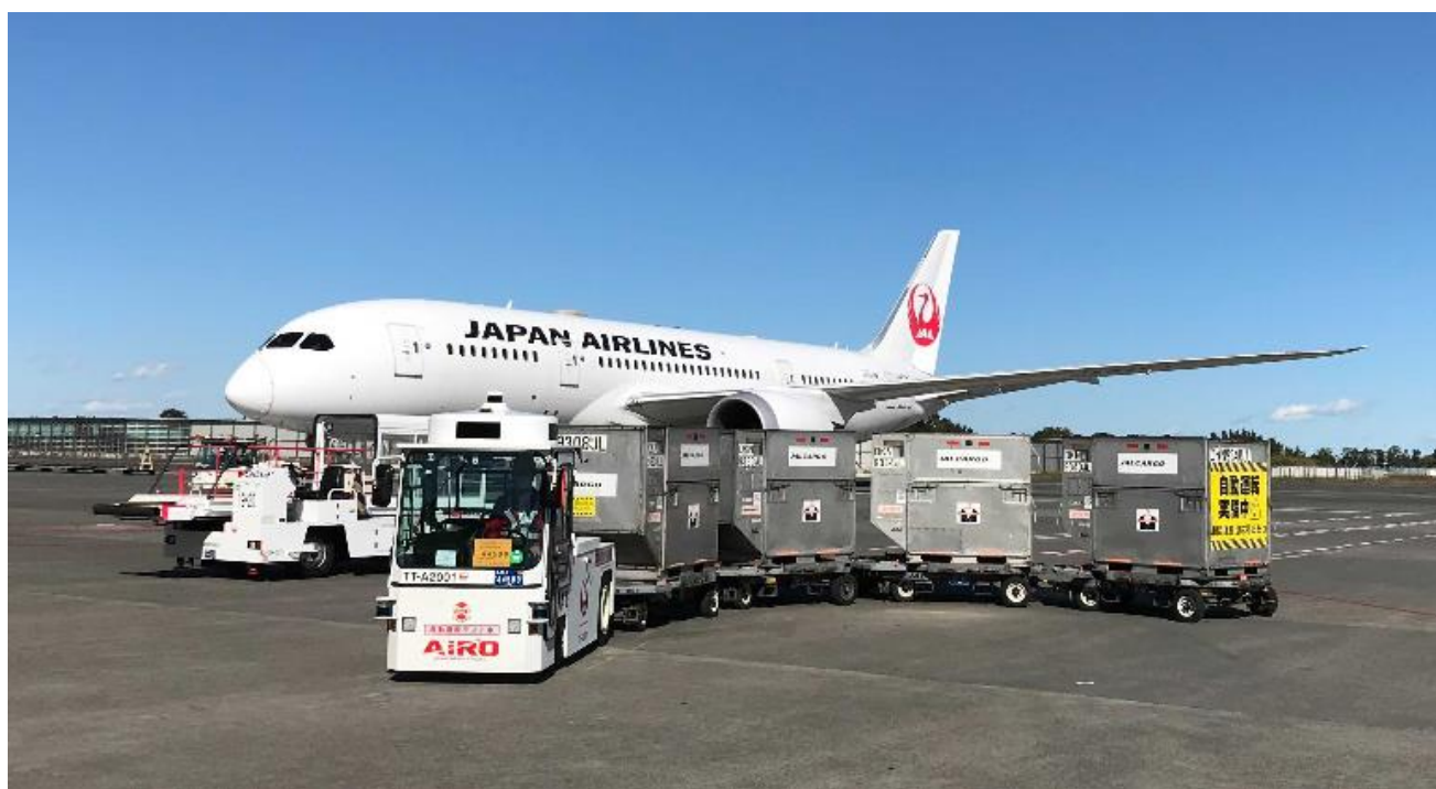
成田国際空港制限区域内における自動走行貨物牽引車
