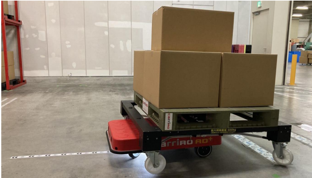
CarriRoAD+パレット積載タイプがライントレーステープ上走行している様子
